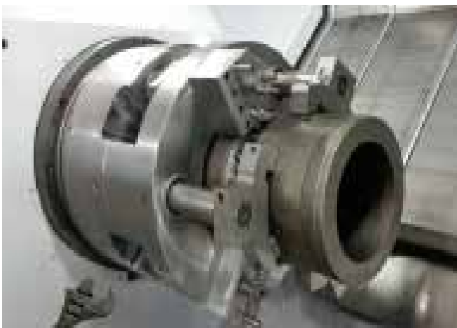
Placa de torno de 24" Hi-LO PC para fixação Camisas para cilindros de locomotiva
