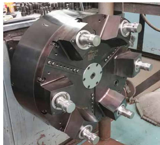
Placa de torno PC de 24" para fixação de tambores de freio de caminhões leves
