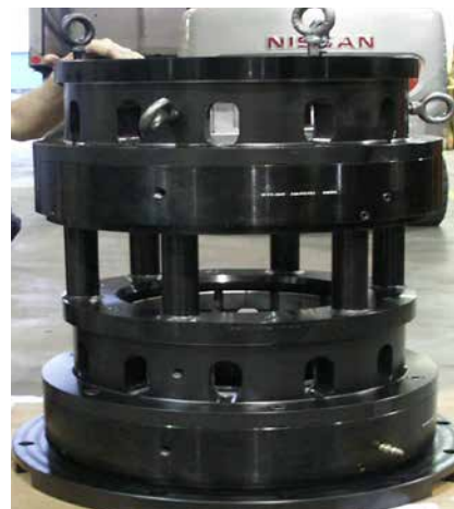
Placa de torno porta-pinça de fixação Rim-Lok DE para fixação de tambor de freio diâmetro de 14"
