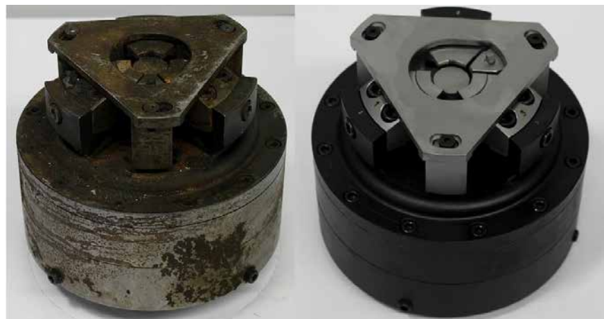
Conjunto de placas de torno de diagrama de 7" com 3 castanhas com ferramental especial
